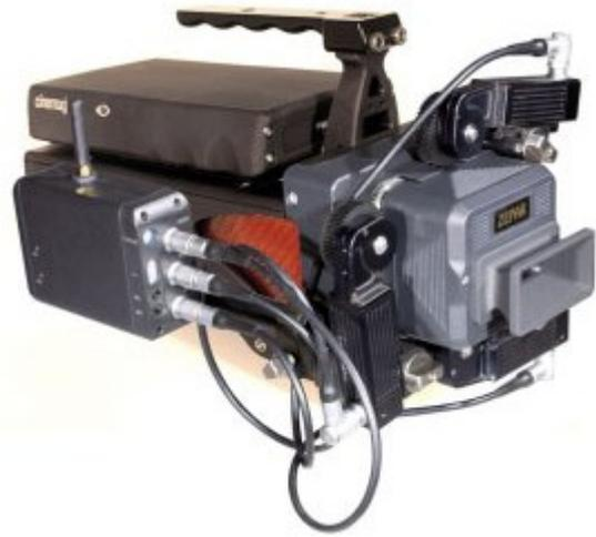
Links: Zepar-Doppelobjektiv an der Phantom 65 mit angekoppeltem CineMag als Hochgeschwindigkeits-Speicher
