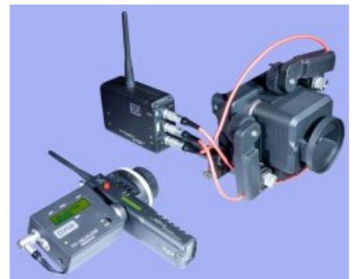
Zepar-Doppel-Objektiv, Dreikanal-Funkfernsteuerung und Empfänger mit Prozessor
